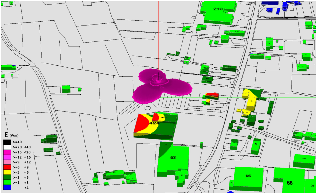
Fig. 2 Impatto Elettromagnetico – zona Parcheggio Polo Industriale – 0° N
